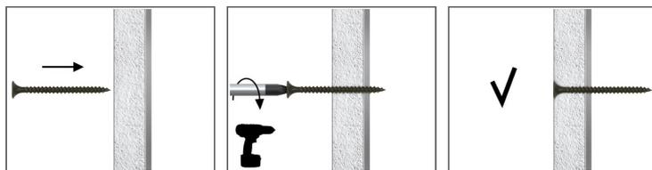
1. Перпендикулярно закрутить винт. Закручивать до момента, пока его головка не сравняется с уровнем поверхности.
