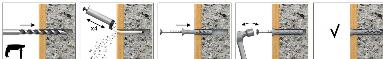
1. Просверлить отверстие, используя сверло необходимого диаметра.
