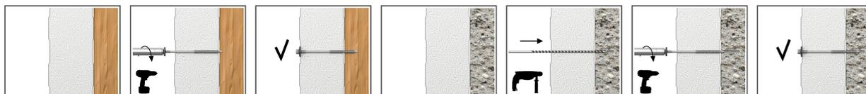
1. Шуруп устанавливается в основании строго под углом 90 градусов
