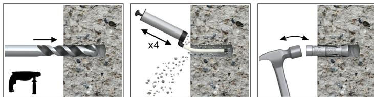
1. Просверлить отверстие необходимого диаметра и с соответствующей глубиной. ПРИМЕЧАНИЕ: В случае закрепления в кирпичной кладке, избегать монтажа анкеров в местах стыков
