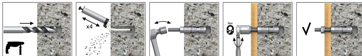
1. Просверлить отверстие необходимого диаметра и с соответствующей глубиной. ПРИМЕЧАНИЕ: В случае закрепления в кирпичной кладке, избегать монтажа анкеров в местах стыков
