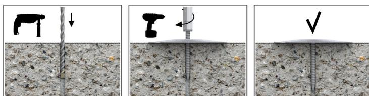
1. Установить шайбу POW на изоляционном материале
